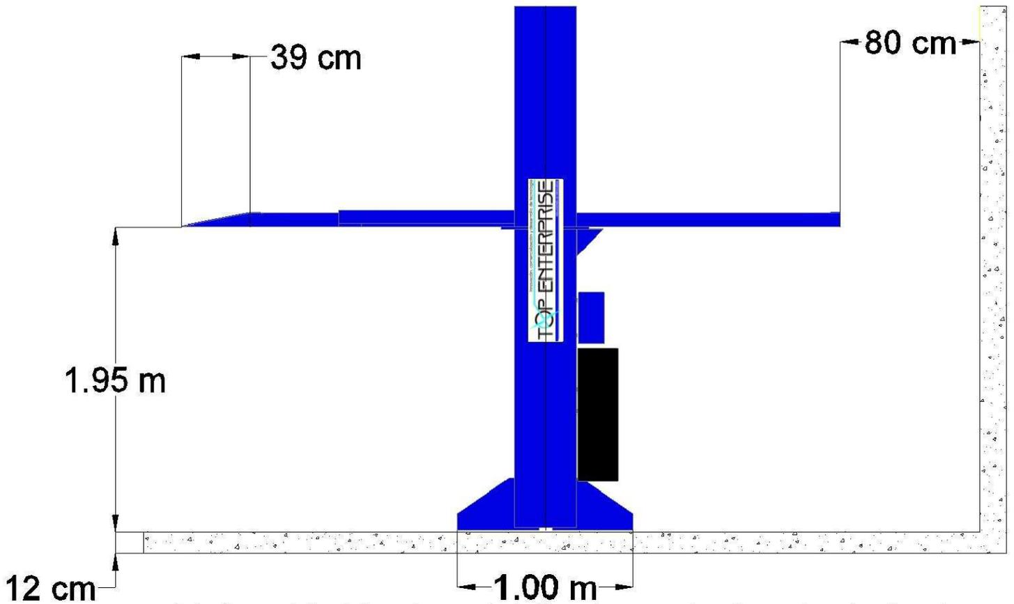
Estructura anclada a la base de concreto de 12 cm de espesor de malla armada preferentemente.
